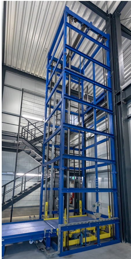
Vertikalförderer mit Gliederbandförderer
