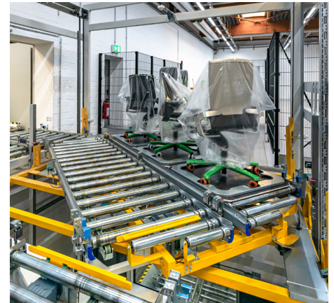
Vertikalförderer mit integrierter Rollenbahn auf einer Drehstation
