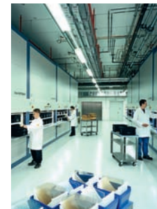
Hänel Rotomat® – raumsparende Lagerung nach dem Paternoster-Prinzip
